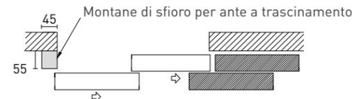
Porta a due ante, trave di scorrimento a due vie con attacco a soffitto e sistema di trascimento.
