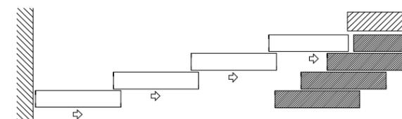
Porta a quattro ante, trave di scorrimento a quattro vie con attacco a soffitto e sistema di trascimento.
