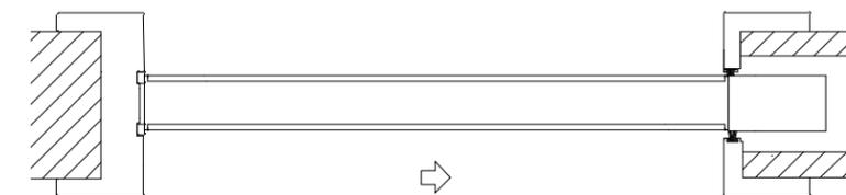
La porta Master scorrevole interno muro può essere predisposta per l'inserimento in cassonetti scorrevoli classici di qualsiasi marca, in questo caso la porta viene corredata di telaio e coprifili in alluminio estruso. I coprifili in alluminio sono disponibili in una vasta gamma di finiture, anche in colore opaco a campione.
