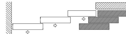
Porta a tre ante, trave di scorrimento a tre vie con attacco a soffitto e sistema di trascimento.
