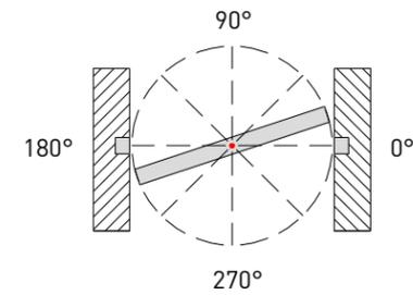
Chiudiporta per anta bilico con perno di rotazione invisibile, telaio con battute laterali.
