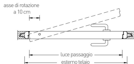
Il modello standard ha dimensioni luce passaggio 100 x 220 cm H, inclusa serratura con scrocco magnetico, piletta a pavimento e ferramenta incassata nel traverso superiore, telaio a filo muro in alluminio argento satinato per pareti in muratura o cartongesso. Maniglia esclusa. Spessori telaio ed anta standard a scelta tra 10,2 - 10,7 - 12,5 cm.
