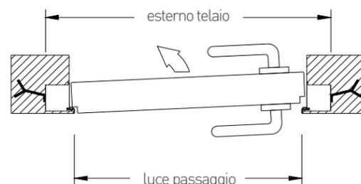
Nel modello standard la luce di passaggio ha dimensioni 60/70/80 x 210 cm H, inclusa serratura con scrocco magnetico, cerniere a scomparsa, telaio a filo muro in alluminio argento satinato per pareti in muratura oppure cartongesso. Maniglia esclusa.
