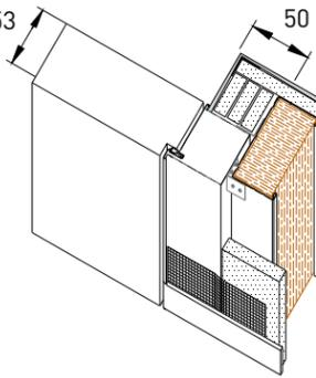
Telaio a filo muro esterno ed interno di serie, in alluminio argento satinato compatibile per pareti in muratura o cartongesso.
