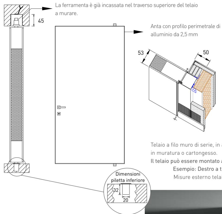
Porta completa con telaio a filo muro in alluminio argento satinato per pareti in muratura oppure in cartongesso, serratura con scrocco magnetico di serie per chiave Patent o nottolino privacy.
