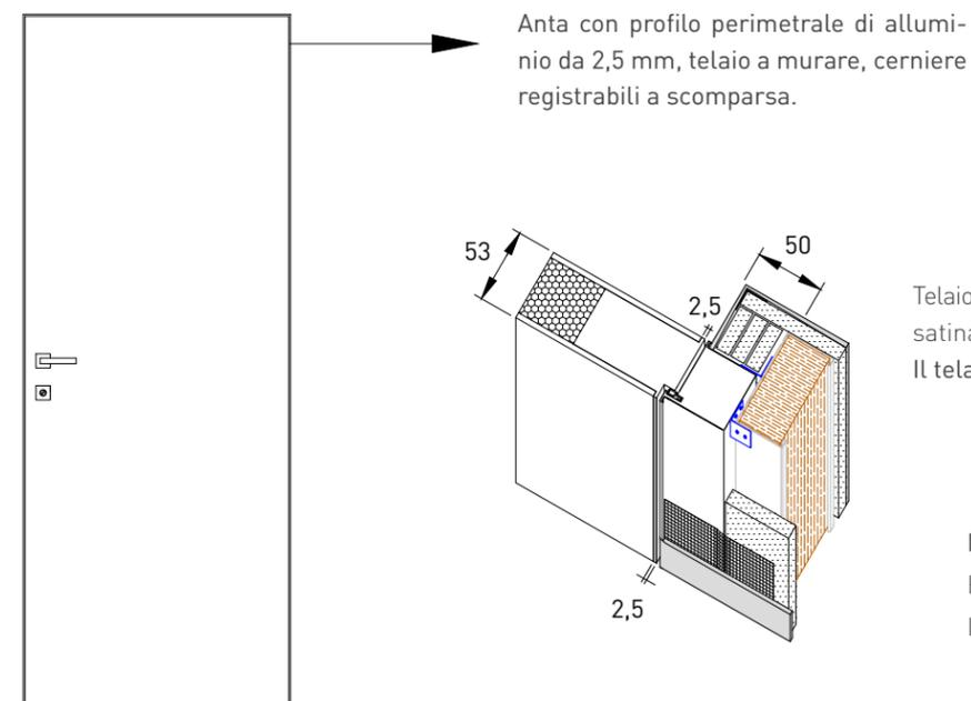
Telaio a filo muro esterno/interno di serie, in alluminio argento satinato compatibile per pareti in muratura o cartongesso. Il telaio può essere montato a tirare oppure a spingere. Esempio: Destro a tirare = Sinistro a spingere
