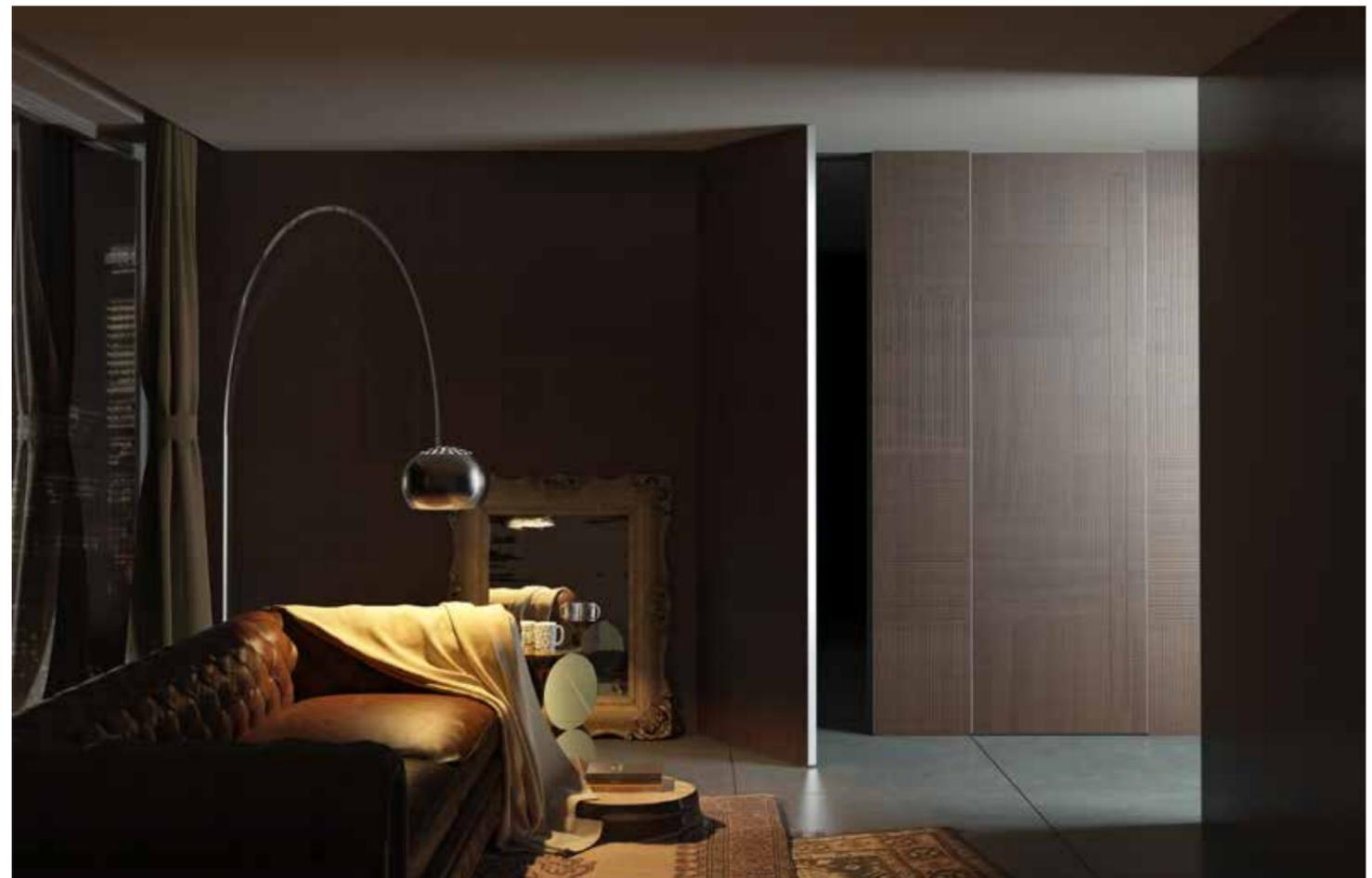
*Boiserie con porta Master integrata. Il sistema di chiusura magnetico non richiede serratura e la maniglia a filo MA16 monta una cover coordinata e intercambiabile.*
